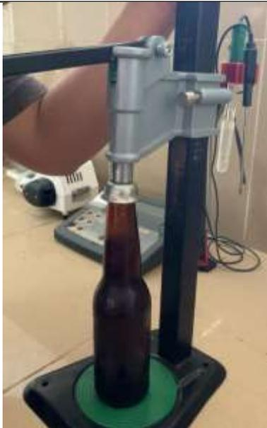
Figura 17: Sellado de las botellas ya envasadas y gasificadas.
